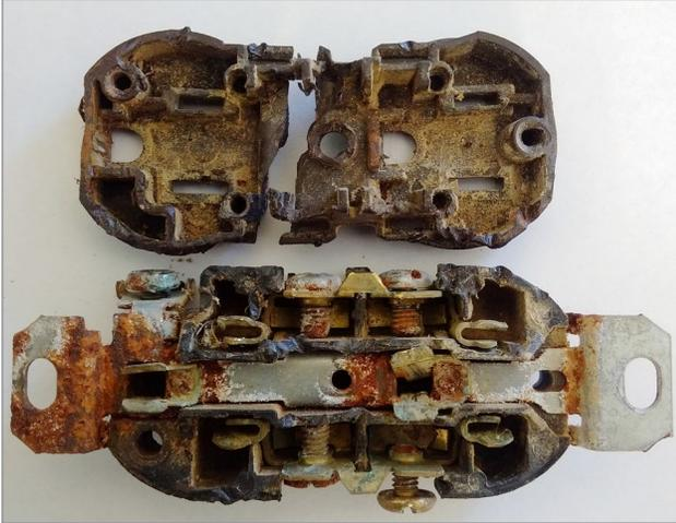
**Figure 3.** Prise corrodée trouvée dans une étable laitière.
