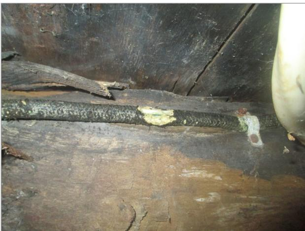
**Figure 5.** Fil électrique endommagé par des rongeurs.
