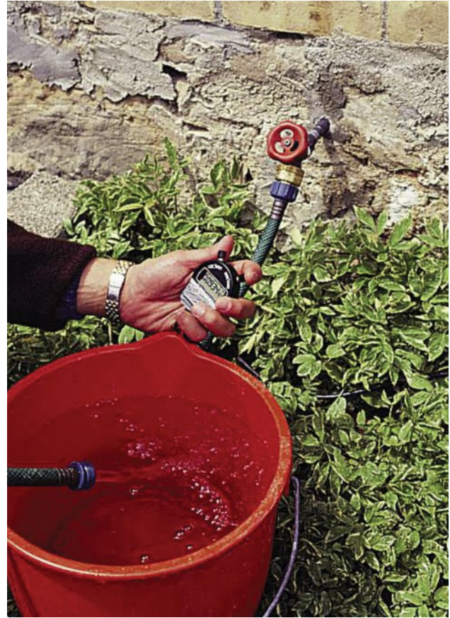
Figure 5. Mesure de la durée requise pour remplir un seau d'eau en actionnant la pompe.
