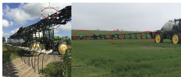
Figure 11-1 – Application d'azote à taux variable en temps réel au moyen de capteurs optiques installés sur un doseur d'engrais Y-Drop. Les capteurs GreenSeeker MC utilisés pour la culture du blé et du maïs sont encerclés en rouge sur la rampe.
