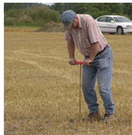
**Photo 8-3a** – Repérer les zones d'un champ susceptibles de présenter des problèmes de compaction au moyen d'une sonde à tuyau ou d'une tige flexible
