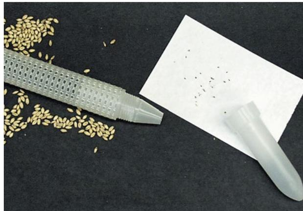
**Photo 12-1** – Dépistage des insectes à l'aide de pièges-sondes insérés dans le grain
