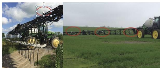
**Figure 11-1** – Application d'azote à taux variable en temps réel au moyen de capteurs optiques installés sur un doseur d'engrais Y-Drop. Les capteurs GreenSeeker<sup>MC</sup> utilisés pour la culture du blé et du maïs sont encerclés en rouge sur la rampe.
