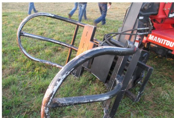
Figure 15-5. Un grappin diminue le risque de perforation de la pellicule de plastique.
