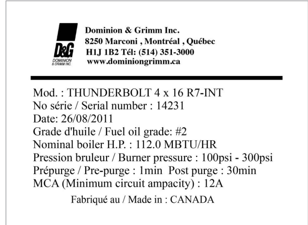
Figure 5. Exemple de plaque signalétique apposée sur un évaporateur de sirop d'érable alimenté au mazout.
