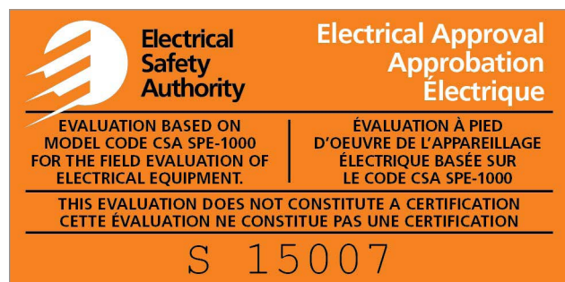
Figure 7. Étiquette d'approbation électrique apposée par l'Office de la sécurité des installations électriques.
