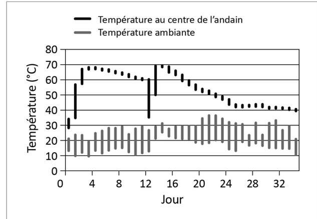
**Figure 4.** Évolution de la température en fonction du temps à l'intérieur de l'andain (retourné au jour 13).
