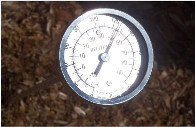
**Figure 3.** Thermomètre à longue tige inséré dans le compost et affichant une température de 51 °C (124 °F).
