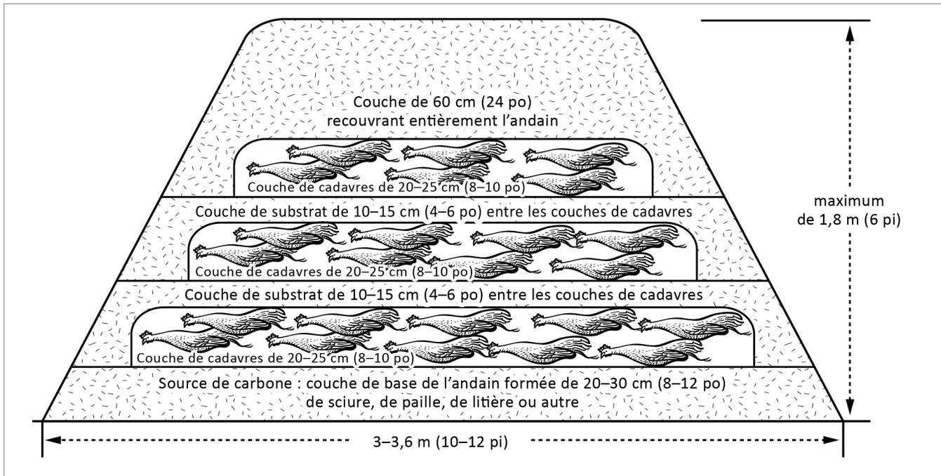
**Figure 2.** Coupe transversale d'un andain de compostage de cadavres de volaille formé par la méthode multicouche.
