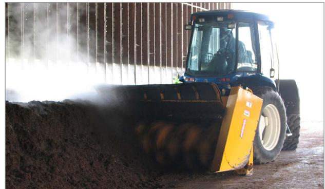
**Figure 1.** Retourneuse d'andains de marque Brown Bear et andain de compost composé de cadavres de volaille et de substrat.
