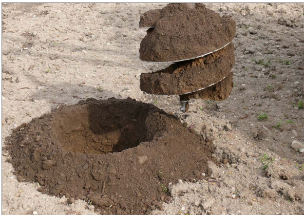
Figure 3. Une tarière montée sur un tracteur permet de creuser une fosse rapidement. Les tarières de plus de 0,6 m (24 po) de diamètre et celles qui s'enfoncent à plus de 1,2 m (48 po) de profondeur sont coûteuses et requièrent une grande puissance de moteur. Les trous creusés à la tarière ne peuvent accueillir que quelques cadavres de petits animaux.
