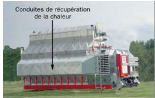
Figure 7. Séchoir à grain à écoulement transversal continu avec les conduites de récupération de la chaleur installées à l'usine. Source : Brock Grain Systems, Milford (Indiana), É.-U.
