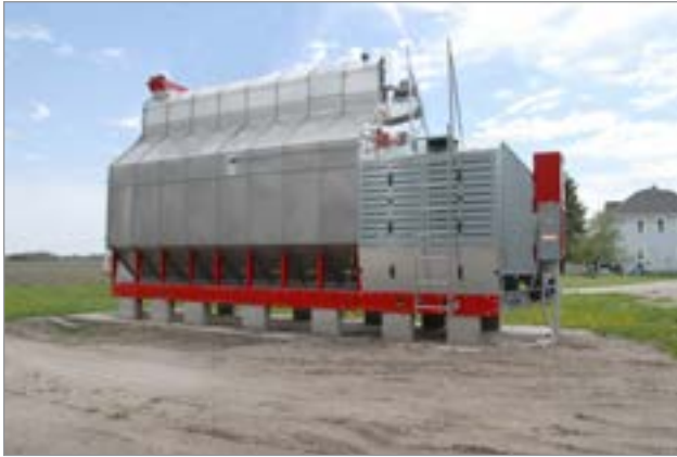
Figure 1. Séchoir à grain classique – il s'agit ici d'un modèle horizontal à écoulement transversal continu sans récupération de la chaleur.
