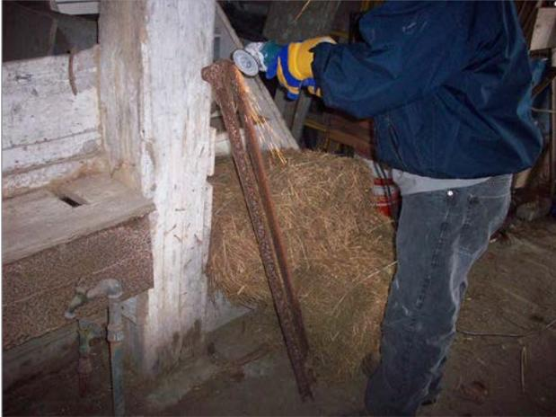
**Figure 4.** Meulage d'une tige en acier à proximité de matières inflammables.
