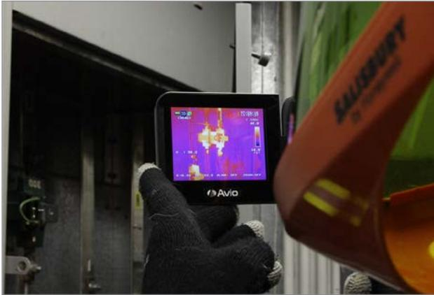
**Figure 5.** Inspection du matériel électrique par le représentant d'une compagnie d'assurances.
