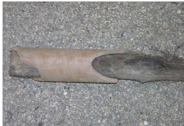
**Figure 5.** Tuyau de drainage obstrué par des racines.
