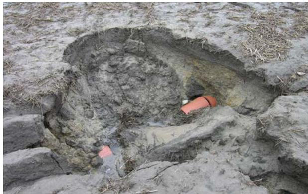
**Figure 6.** Tuyau de drainage ayant éclaté.
