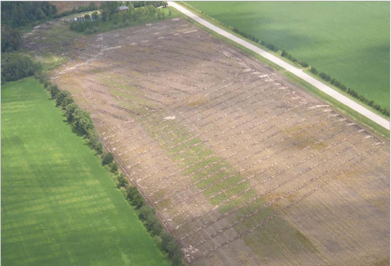
**Figure 1.** Vue aérienne d'un réseau de drainage souterrain d'installation récente.
