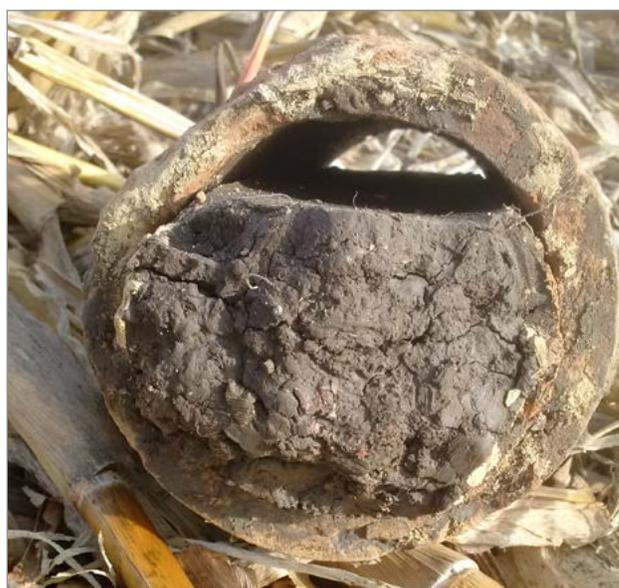
**Figure 8.** Vieux tuyau d'argile rempli de sédiments.
