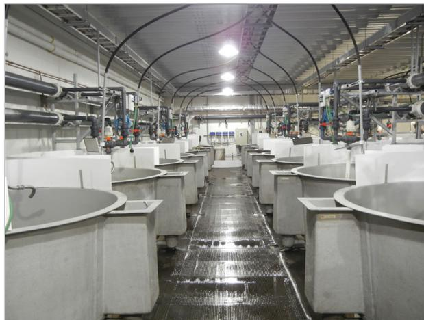
**Figure 4.** Écloserie d'un système d'aquaculture en recirculation dans le Sud de l'Ontario.
