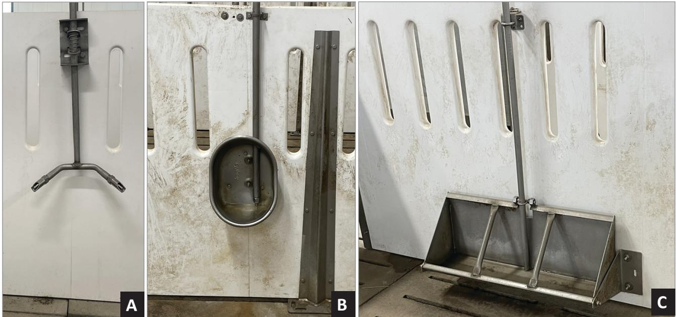
**Figure 1.** Un abreuvoir à tétine (A), un abreuvoir à bol (B) et un abreuvoir à auge (C).
