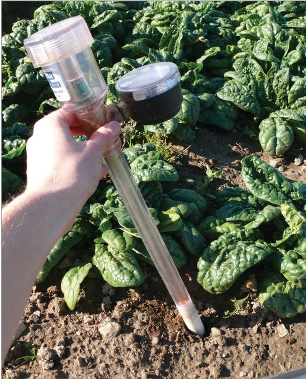
**Figure 2.** Mesure prise à l'aide d'un tensiomètre, appareil servant à mesurer le niveau d'humidité du sol.
