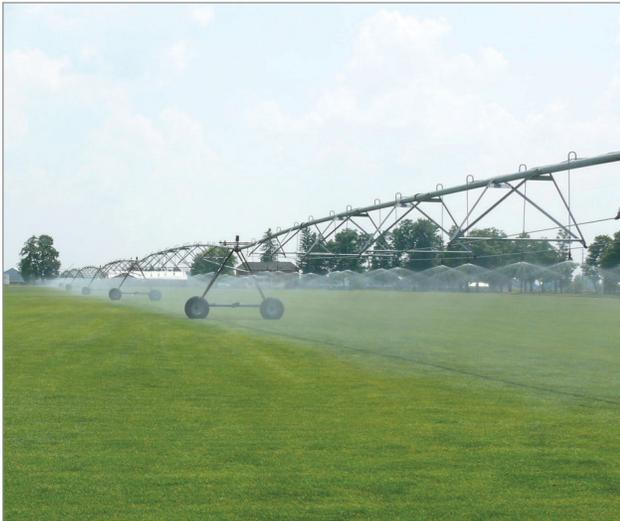
**Figure 1.** Irrigation dans une gazonnière au moyen d'un système à déplacement latéral muni de buses à faible pression.
