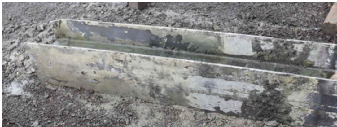
Figure 5 : Les pieux de l'échangeur entre l'autoroute 401 et le chemin Hallecks présentent une faible corrosion
